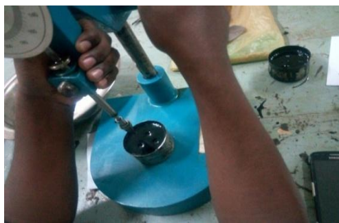
Fig: Penetration Test
